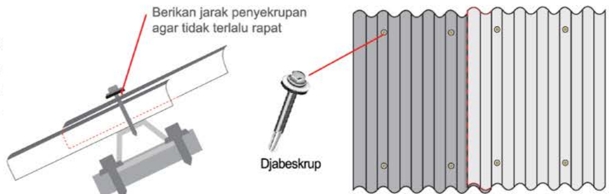
Ket : Posisi Penyekrupan dilakukan pada satu gelombang setelah tumpukan
