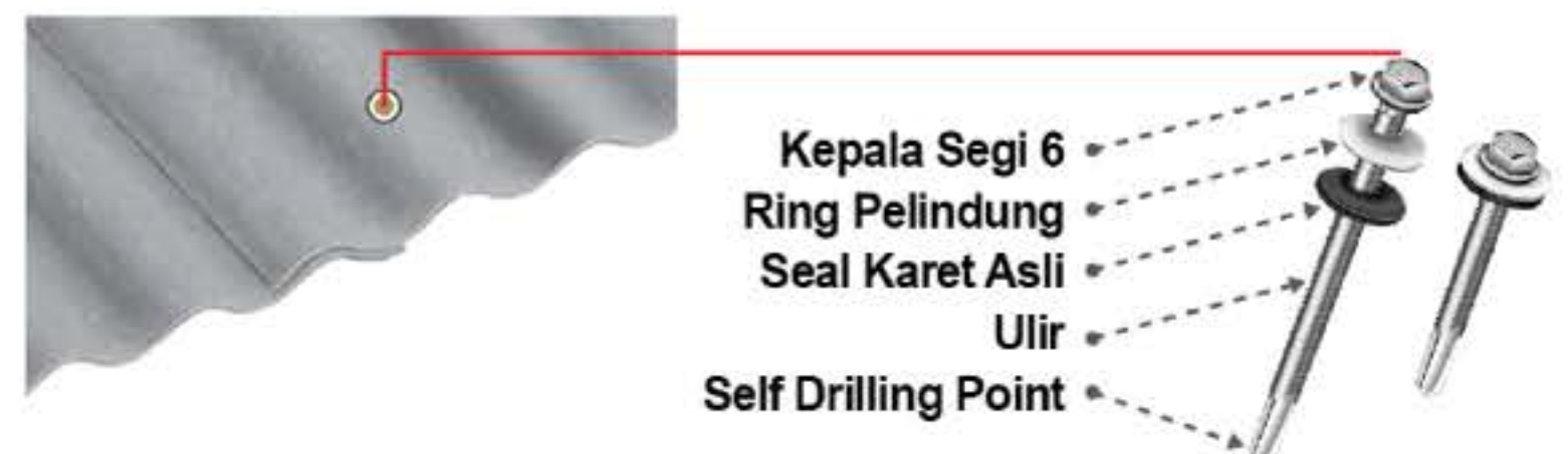
Ket : Posisi Penyekrupan dilakukan pada satu gelombang setelah tumpukan
